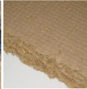
ノコギリ、糸のこは裁断面が荒くなり、密着性が悪くなります。
