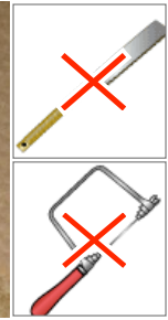
ノコギリ、糸のこは裁断面が荒くなり、密着性が悪くなります。
